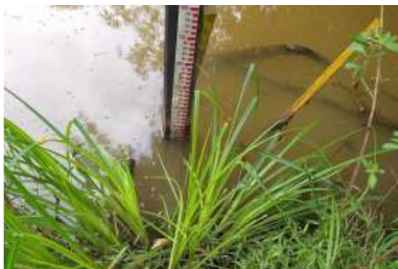
Figura 09 Régua linimétrica instalada no reservatório
