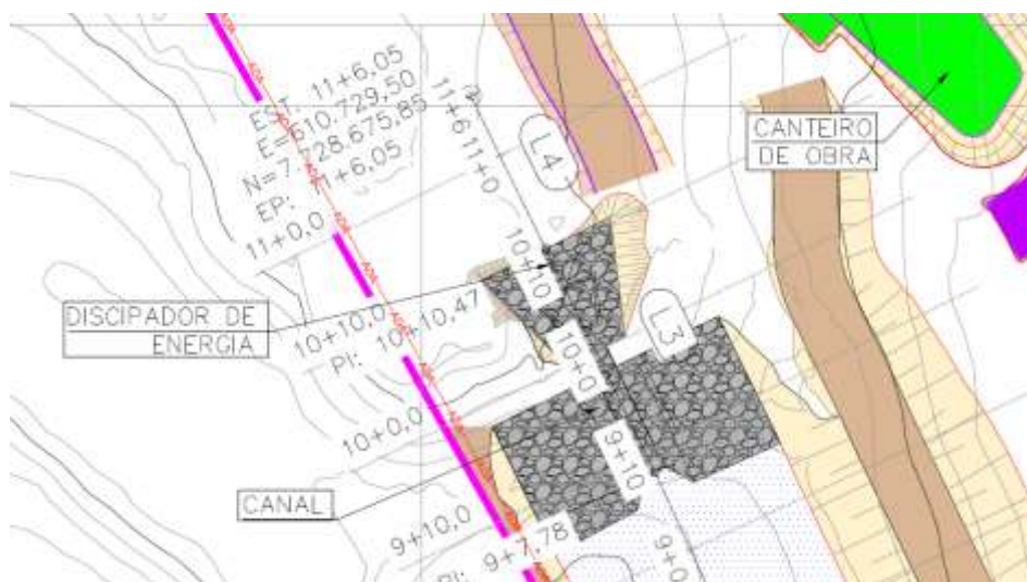
Figura 16 Implantação Canal e bacia de dissipação na Barragem Caetano Lopes.
