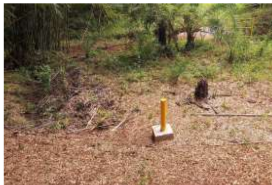
Figura 10 Medidor de nível de água.
